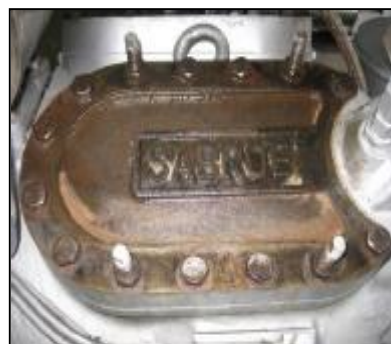
ฝาสูบที่ล้างด้วยน้ำเปล่า เมื่อใช้ Micro-Nice®D-5
