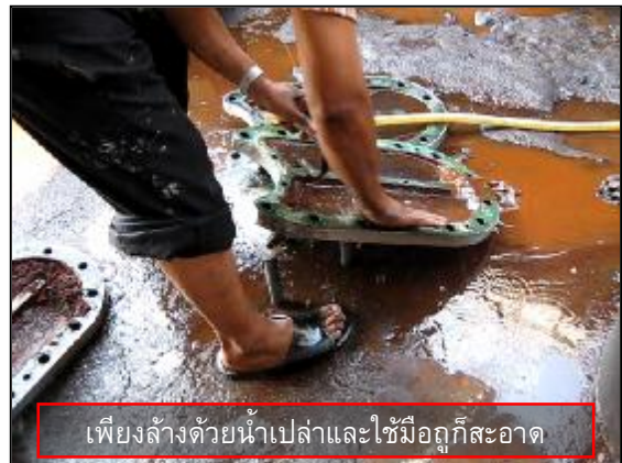
มีตะกรันที่ละลายเป็นโคลนอยู่ภายใน
