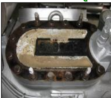
ฝาสูบ Compressor ที่มีตะกรันแข็งเกาะแน่น
